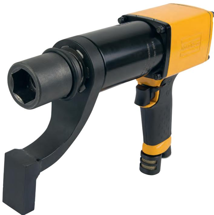
ГАЙКОВЕРТ RTP имеет небольшой вес и высокоскоростной мощный двигатель для затяжки винтовых соединений на крупных болтах. Прочный и легкий реактивный упор предохраняет оператора от реактивной силы гайковерта. Уровень шума и вибрации ниже, чем у обычных гайковертов ударного действия.
